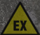
ACHTUNG EXPLOSIONSGEFÄHR- -DETE ZONE
